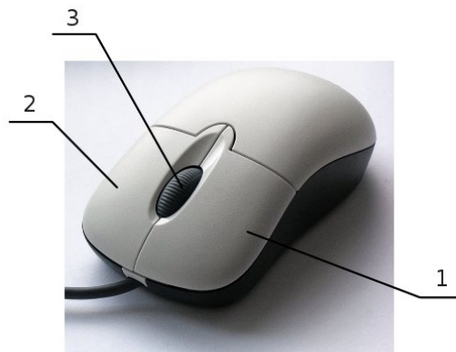
Slika 7.3.2 Kompjuterski miš sa dva tastera, levim tasterom (1), desnim tasterom (2), i točkićem (3)
