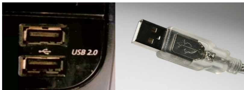
Slika 7.2.4 USB priključci, dva ženska (levo) i muški (desno)
