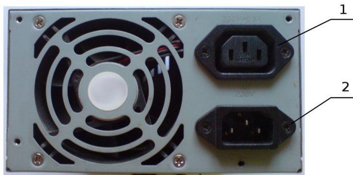
Slika 7.1.5.2 Zadnja strana napajanja gledano sa zadnje strane kućišta računara sa ženskim (1) odnosno muškim (2) priključkom za električni provodnik
