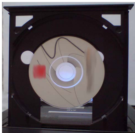
Slika 7.1.4.6 Otvorena fioka jedinice optičkog diska sa pravilno postavljenim malim diskom u njoj
