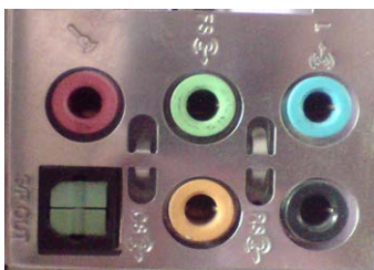
Slika 7.5.4 Ženski audio priključci na matičnoj ploči gledano sa zadnje strane kućišta računara
