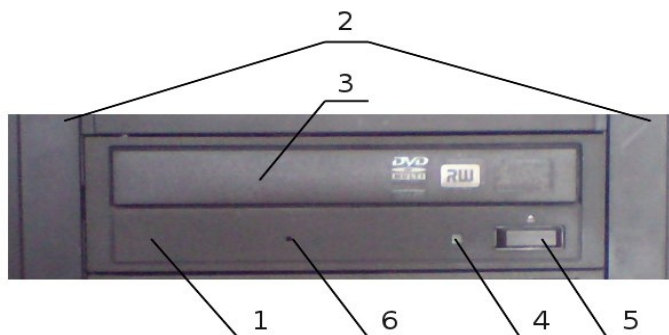
Slika 7.1.4.2 Vidljivi deo jedinice optičkog diska kada je ona povezana sa računarom
