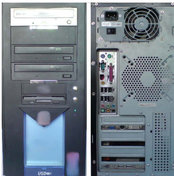
Slika 7.1.2 Prednja i zadnja strana sklopljenog kućišta računara
