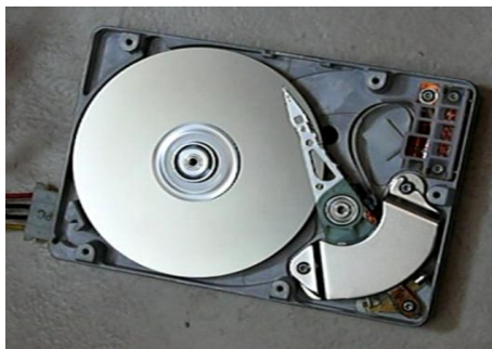
Slika 7.1.3.1 Unutrašnjost hard diska
