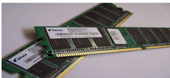
Slika 7.1.1.2.1 Izgled dva modula Ram memorije izdvojenih od ostatka računarskog sistema
