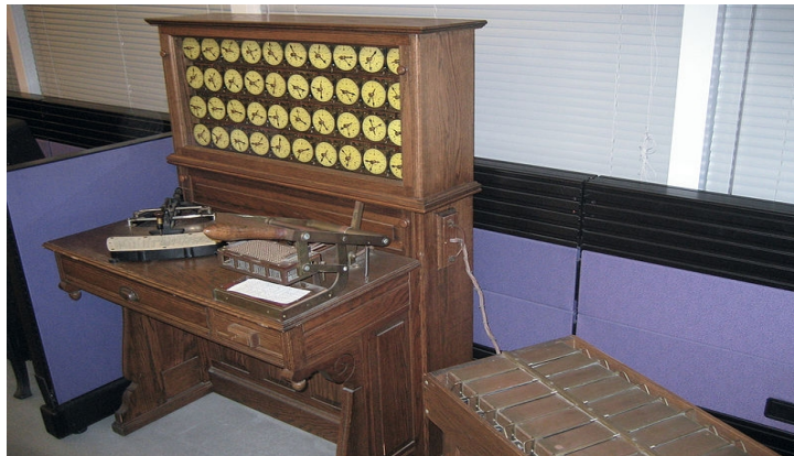
Slika 2.3.2.1 Elektromehanička mašina sa brojačima
