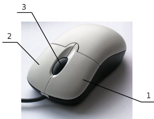
Слика 7.3.2 Компјутерски миш са два тастера, левим тастером (1), десним тастером (2), и точићем (3)
