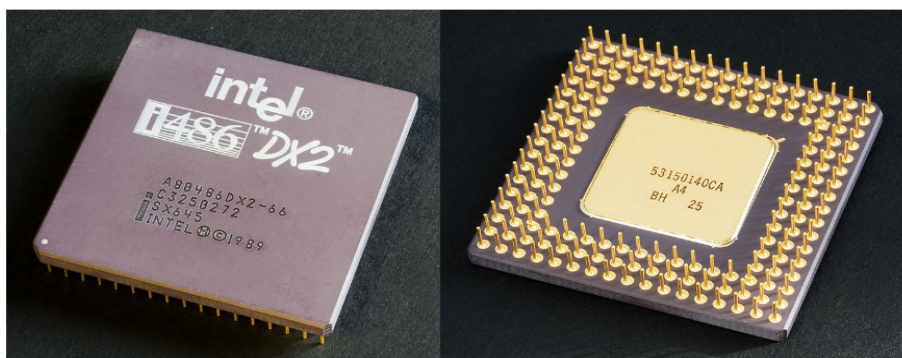
Слика 7.1.1.1.1 Микропроцесор Intel 80486DX2 окренут лицем (лево) и наличјем (десно) према нама, издвојен од остатка рачунарског система
