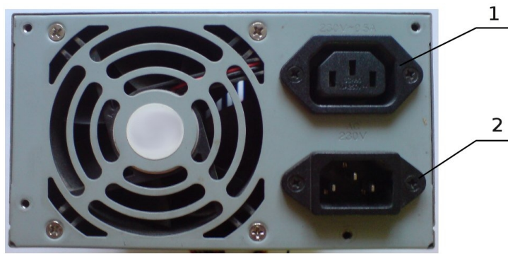
Слика 7.1.5.2 Задња страна напајања гледано са задње стране кућишта рачунара са женским (1) односно мушким (2) прикључком за електрични проводник
