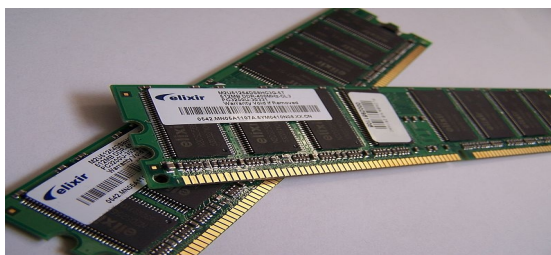
Слика 7.1.1.2.1 Изглед два модула Рам меморије издвојених од остатка рачунарског система
