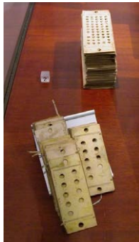
Слика 2.3.1.2 Две врсте бушених картица коришћених за програмирање машине. У првом плану су оперативне карте за унос инструкција, а у позадини променљиве карте за унос података
