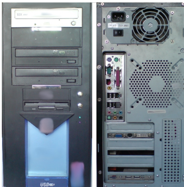
Слика 7.1.2 Предња и задња страна склопљеног кућишта рачунара
